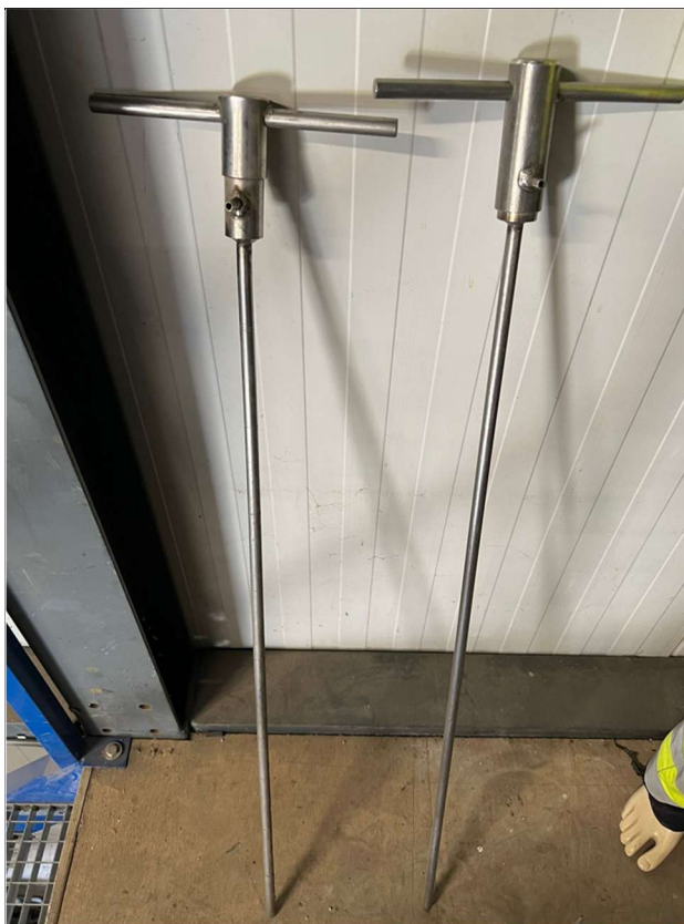
Figuur 4.3 Meetlans voor PID-metingen in de bodem
